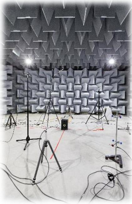
Une chambre semi- anéchoïque (CA), appelée aussi «chambre sourde», est un espace d'expérimentation acoustique bien spécifique. Ses caractéristiques particulières, à savoir une absorption des ondes sonores par les parois, et une isolation importante par rapport à l'extérieur, offrent une qualité de mesure dite en champ libre en limitant fortement le niveau de bruit de fond perturbateur.
